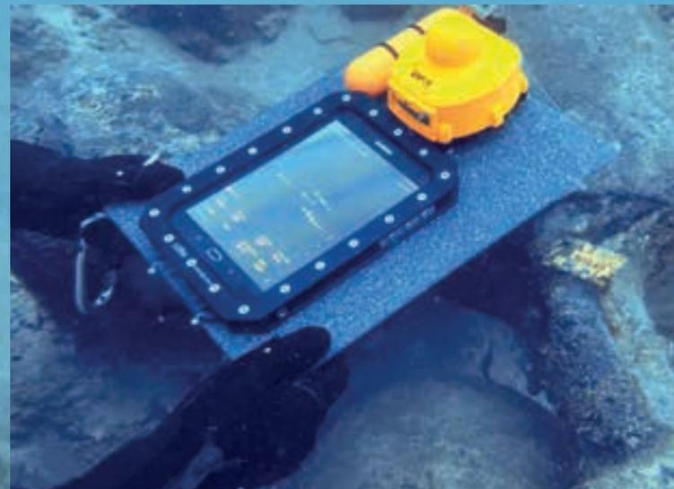
Mit der Unterwassereinheit (gelb) konnte die Position der Referenzpunkte und einiger ausgewählter und markierter Amphoren bestimmt werden.
